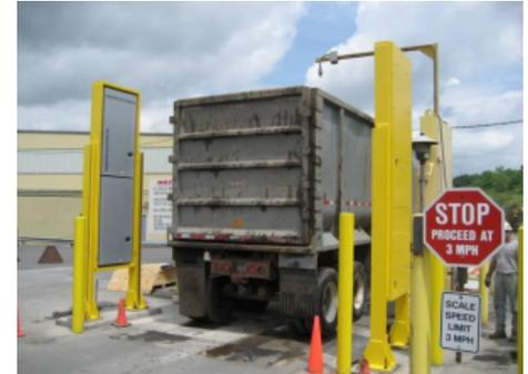
Het systeem is volledig modulair, waardoor het gemakkelijk kan worden geconfigureerd om te voldoen aan de lokale logistiek en snel en eenvoudig onderhoud mogelijk maakt. Het systeem werkt onafhankelijk en heeft directe Ethernet-connectiviteit met fabrieksnetwerken. Deze connectiviteit maakt een volledig geïntegreerd fabrieksontwerp mogelijk met de mogelijkheid voor RSO-overzicht op alle geïnstalleerde systemen.
