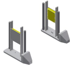
De Gen IV-serie RPM-systemen zijn robuuste, grote plastic scintillatiesystemen die optimaal kunnen worden ingericht om bewegende voertuigen die het systeem binnenkomen te monitoren. Elk detectorsysteem kan worden geconfigureerd met twee tot zes grote detectoren.
