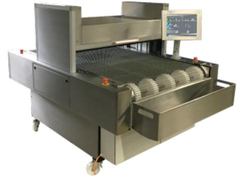
Detectoren, die zo zijn geplaatst dat dode zones worden verminderd, meten materialen op de bewegende transportband door de tunnel, zowel boven als onder. Een touchscreen naast de gebruiker op een bewegende arm zorgt voor een gemakkelijke en eenvoudige bediening tijdens metingen en in de servicemodus.
