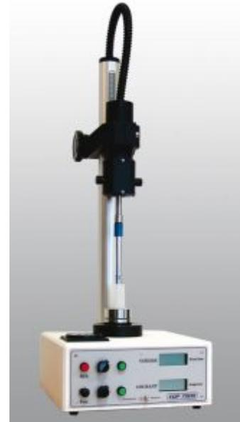
Het Single Mast Electrodeposition Equipment - EDP 7000-systeem is het meest efficiënte principe voor het vangen van een radio-element in een vloeibare oplossing. Dit principe maakt het mogelijk om de radio-isotopen in een oplossing op een metalen plaat af te zetten. Om de hoeveelheid opgevangen radio-elementen te meten, wordt de metalen plaat daarna in een geschikte machine (spectrometer of andere) geplaatst.
