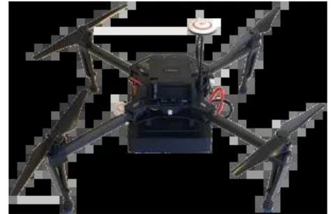
Wanneer het AARM-payloadsysteem van Kromek op een multirotor-dronemodel wordt gemonteerd, kan het worden gebruikt om snelle, gedetailleerde radiologische onderzoeken over grote gebieden uit te voeren. Het geavanceerde sensorsysteem van geïntegreerde stralings- en positiesensoren maakt het mogelijk isotopische vingerafdrukken, tellingen per seconde en volledige spectrale gegevens te verzamelen en vervolgens elke seconde aan de gebruiker te leveren.
